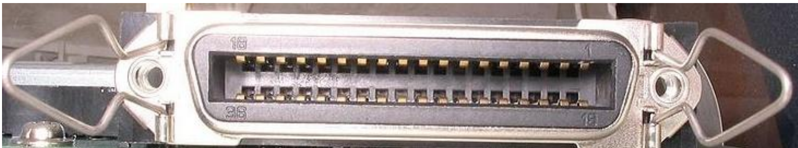
Złącze Micro Ribbon (Centronics 36) w drukarce/skanerze
